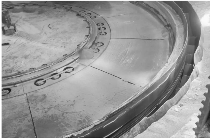
Рис.4. Характер зношування поверхні помольного стола.
