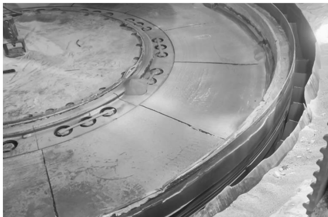
Рис.4. Характер зношування поверхні помольного стола. Fig. 4. Wear pattern of the grinding table surface.
