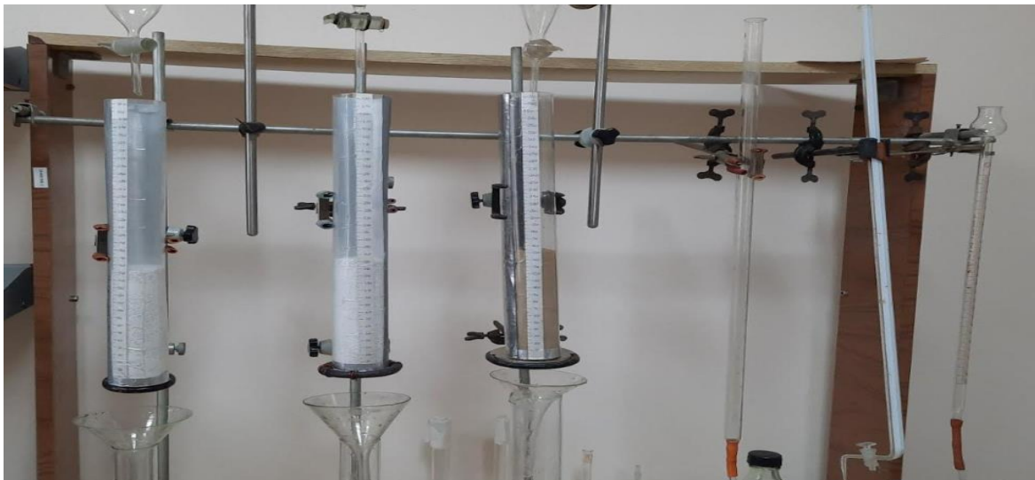
Рис.2. Експериментальні колонки з глинистими зразками перед проведенням дослідів Fig. 2. Experimental columns with clay samples before the experiment
