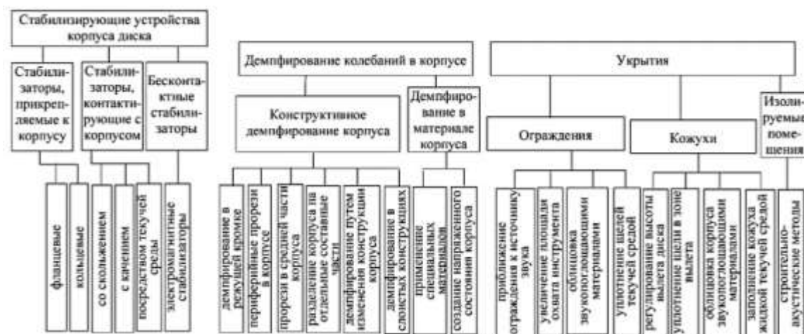
Рис. 2. Классификация методов и средств снижения вибрации и шума режущего инструмента
