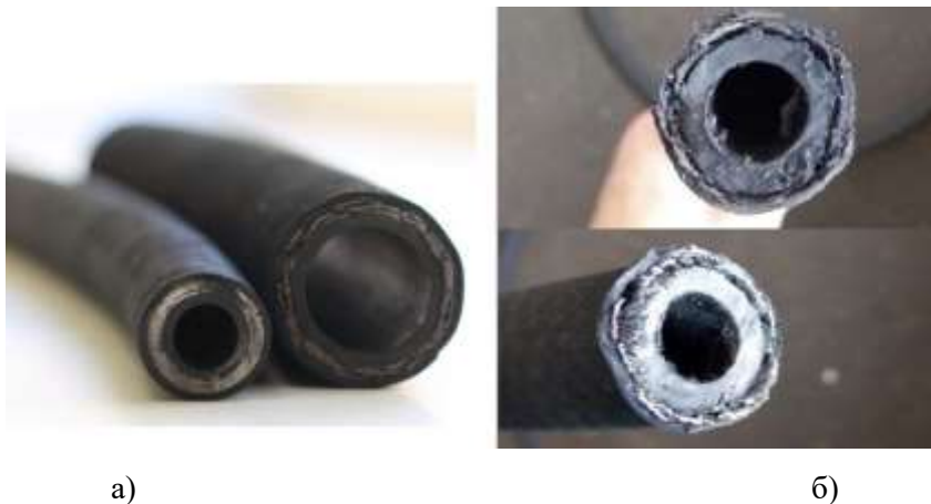
Рис. 3. Торцеві зрізи РВД: а) – на автоматичній машині; б) – на ручній машині
