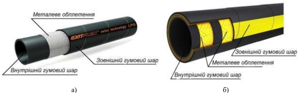
Рис. 1. Структурна схема рукава високого тиску:
