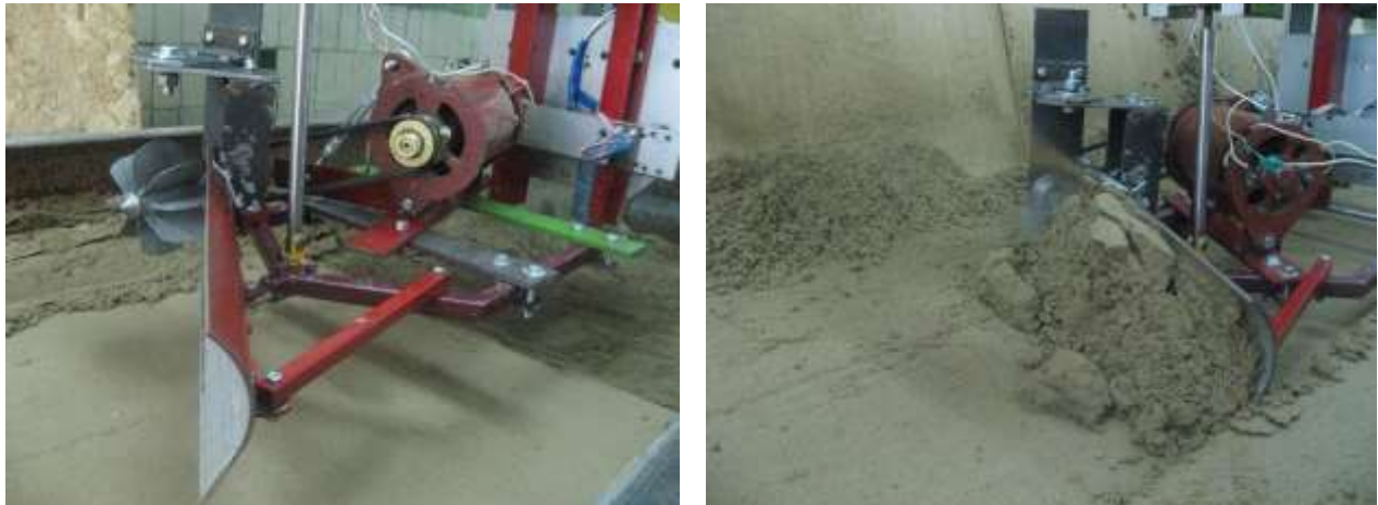
Рис. 2. Фізична модель косовстановленого відвала із сферичним лопатевим метальником: а – фізична модель; б – робочий процес копання ґрунту
