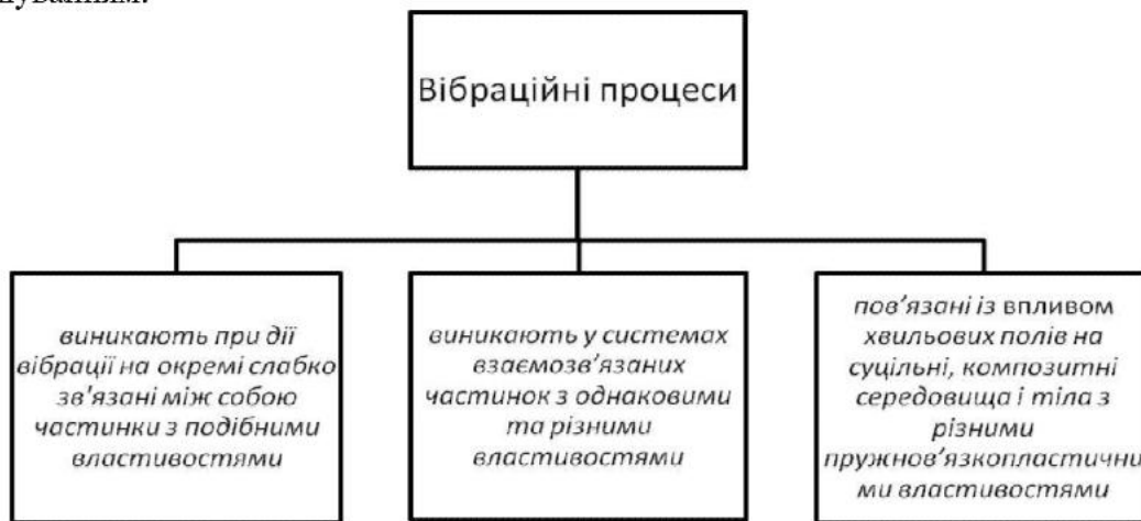
Рис. 1. Поділ вібраційних процесів на групи за типом оброблювального середовища
