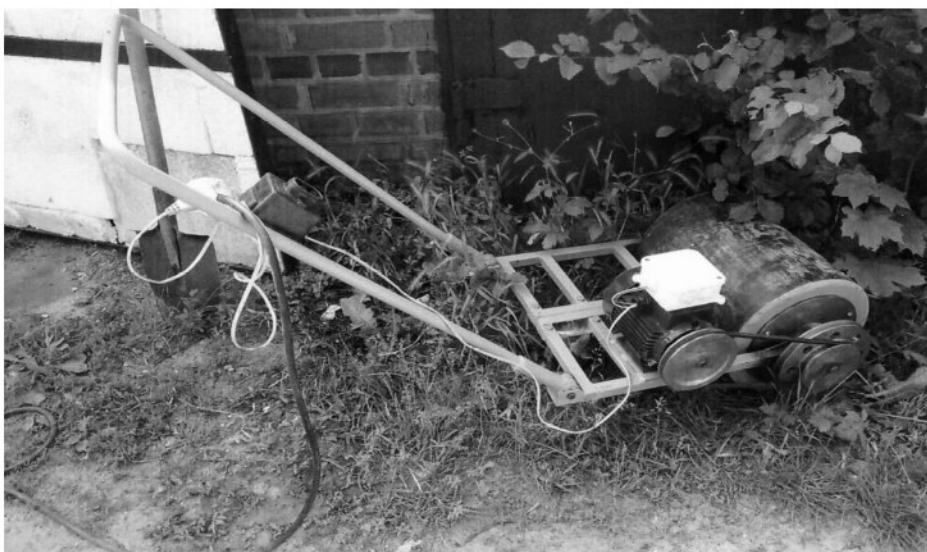
Рис. 7. Ручний віброкоток для ущільнення ґрунтів та дорожніх покриттів
