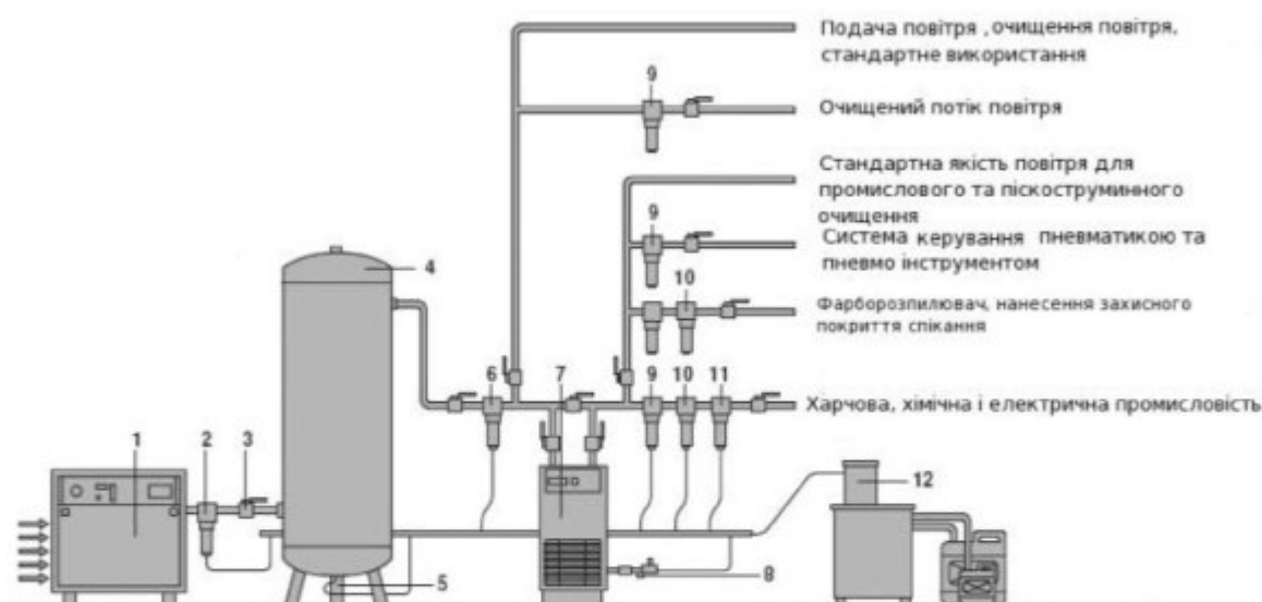
Рис. 1. Схема побудови пневмосистеми залежно від видів кінцевого споживання стисненого повітря: 1 - компресор; 2-циклонний сепаратор; 3 - кран; 4 - ресивер; 5 - автоматичний пристрій для зливу конденсату; 6-керамічний порошковий фільтр AQF 3мкм; 7 - осушувач; 8 - електропристрій для зливу конденсату; 9 - надточний фільтр типу APF 1мкм; 10 - Фільтр тонкої очистки типу АНР 0.01мкм; 11 - вугільний фільтр типу АСР 0.003; 12 - водно - масляний сепаратор
