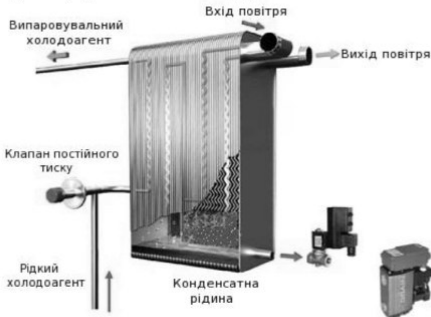
Рис. 6. Схема осушувача рефрижераторного типу
