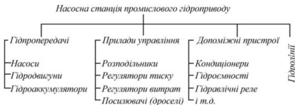
Рис. 1. Елементи насосної станції промислового гідроприводу
