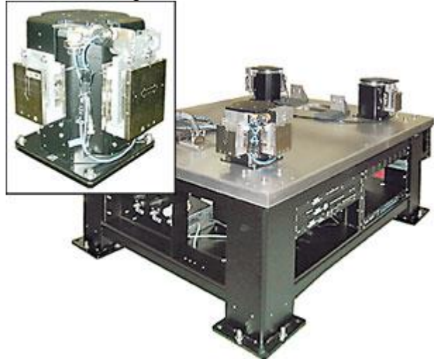
Рисунок 2. Вібраційна установка TMC (США): діапазон частот – >100 Гц; кількість ступеней вільності – 6; тип приводу – електромагнітні збуджувачі; цифрова система управління.
