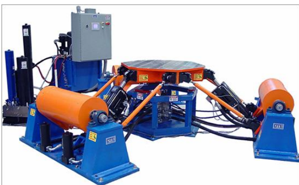
Рисунок 3. Вібраційна установка фірми DTE (США): діапазон частот – 50...150 Гц; кількість ступеней вільності – 3; тип приводу – гідравлічний; комп'ютерна система управління.
