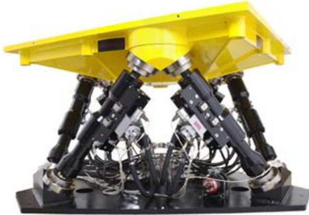
Рисунок 1. Вібраційна установка MOOG (США): діапазон частот – низькі, середні, високі; кількість ступеней вільності – 6; тип приводу – гідравлічний сервопривод; комп'ютерна система управління режимом коливань.
